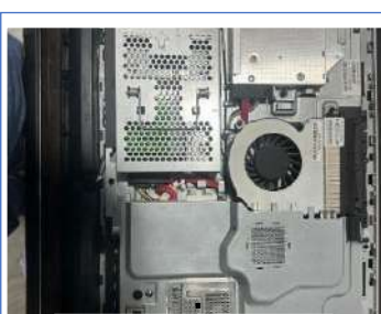
Repotenciacion de equipos en cambio de disco duro y aumento de memoria RAM
