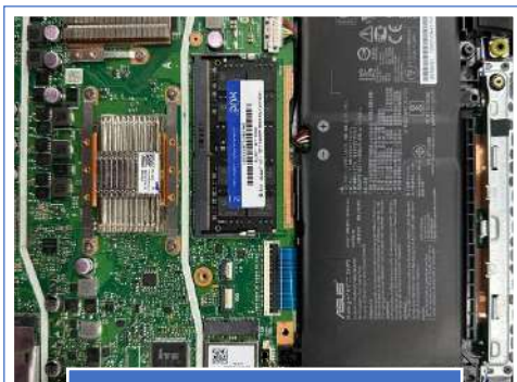
Mantenimiento preventivo e instalacion de memoria RAM DDR4 de 16GB
